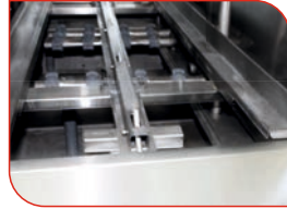
» Sağlaştırdırılmış konveyör taşıma hattı Reinforced conveyor carrying line
